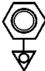
Caso necessário, conecte o gerador eletrocirúrgico ao conector de equalização de potencial do hospital com cabo apropriado.
