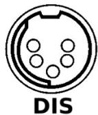
Tomada que permite impedir a ativação das saídas do gerador. Essa funcionalidade provê um meio para outro equipamento desabilitar as saídas do gerador quando necessário. O acionamento dessa porta acontece quando os pinos 1 e 3 do conector são curto circuitados.
