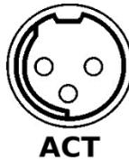
Saída do tipo contato seco, normalmente aberta, que é acionada quando qualquer saída do gerador é ativada. Essa funcionalidade provê um meio de sinalizar para outros equipamentos que o gerador está emitindo RF. A saída de contato seco está ligada aos pinos 2 e 3 do conector.
